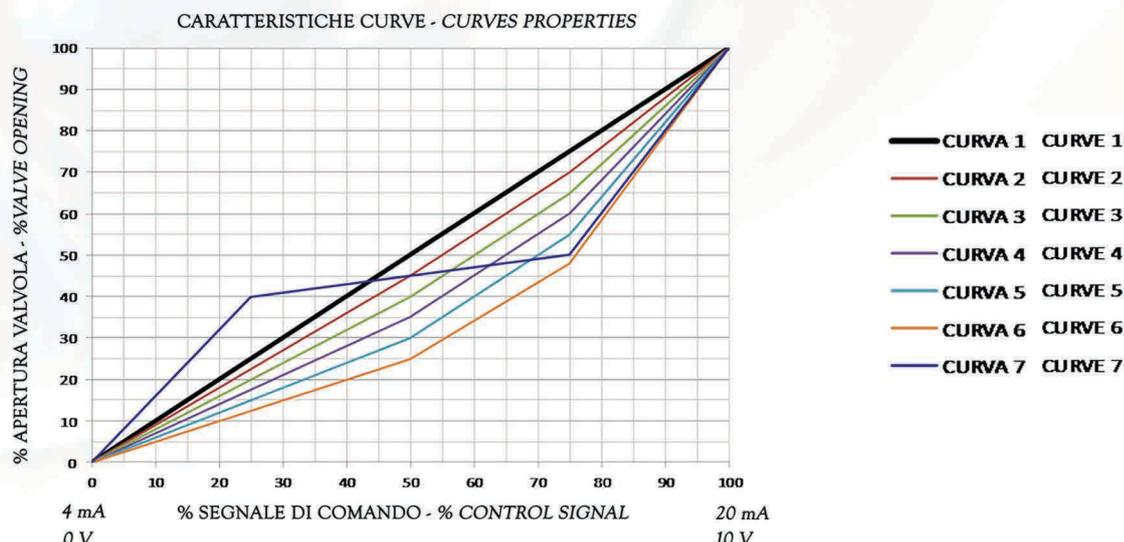
LE CURVE POSSONO ESSERE UTILIZZATE PER PERSONALIZZARE A PARITÀ DI SEGNALE ELETTRICO DI COMANDO IL TIPO DI APERTURA E CHIUSURA DELLA VALVOLA TRAMITE IL DISPOSITIVO.
